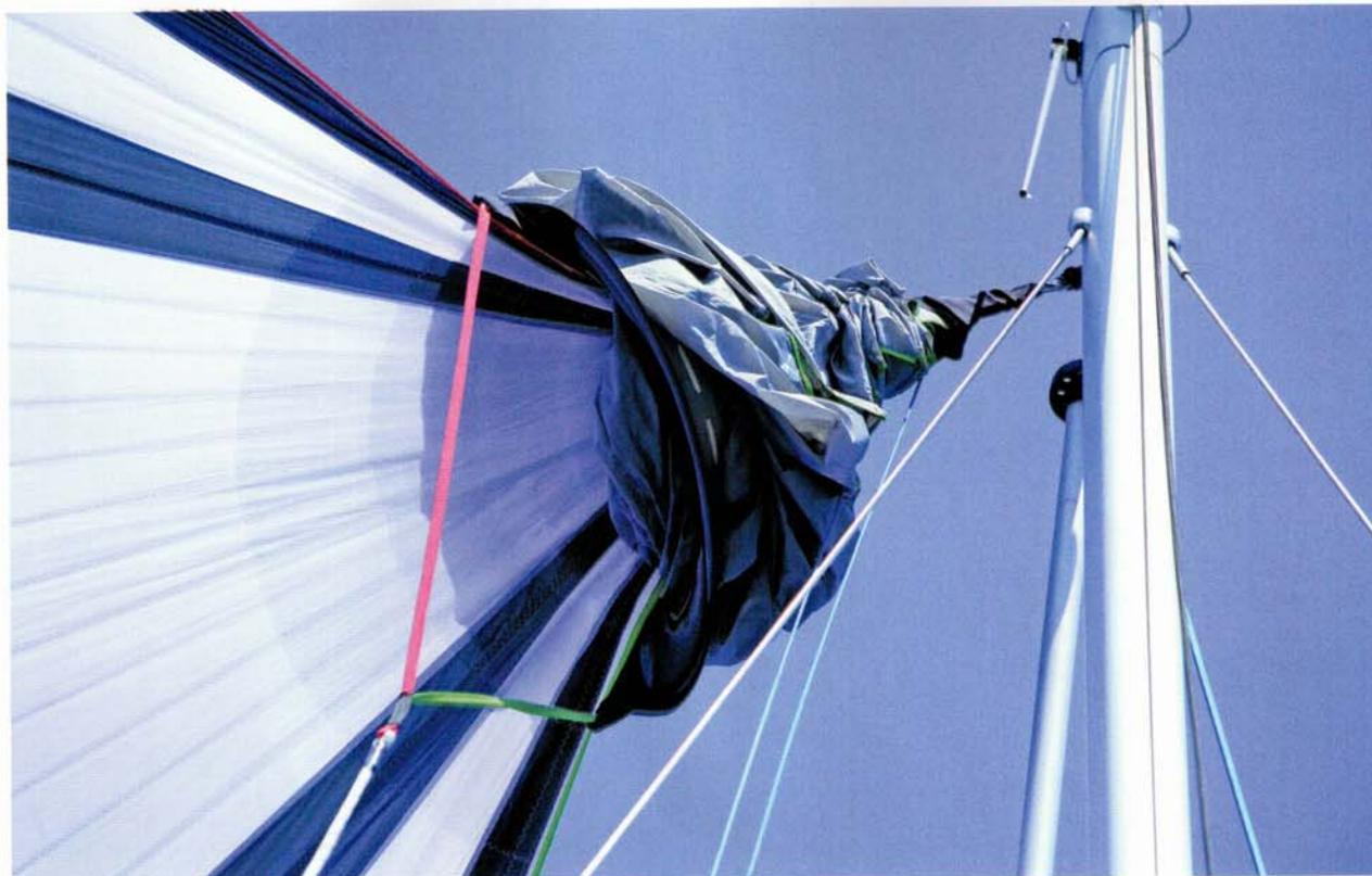
Ein Bergeschlauch vereinfacht das Setzen und Bergen des Spis oder Gennakers und spart so einige Hände an Deck. In diesem Fall sind die Lieken zusätzlich im Trichter geführt und farbige markiert.
