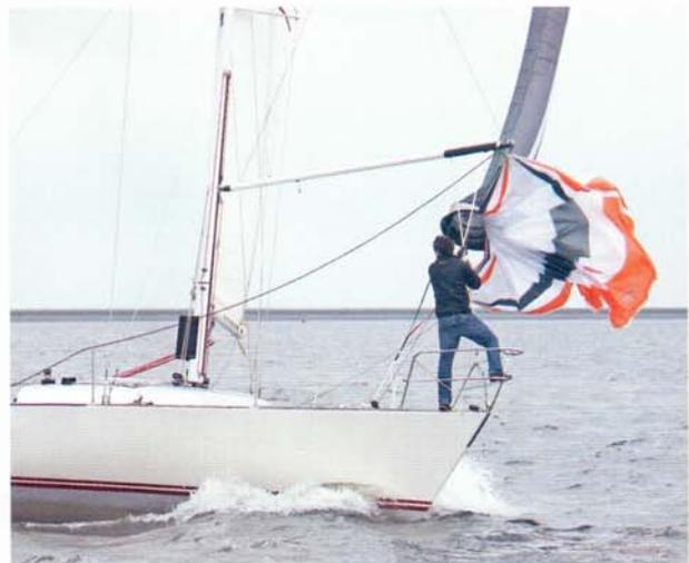
Auch das Bergen gelingt ohne größeren Aufwand. Nach leichtem Fieren der Schoten wird der Schlauch wieder über das Segel gezogen und die Heißleine fixiert.
